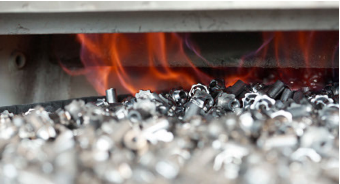
Die neue Wärmebehandlungsanlage ist erstmals mit abgasarmen FLOX-Brennern ausgestattet. Dadurch kann der CO 2 -Ausstoss reduziert werden.
